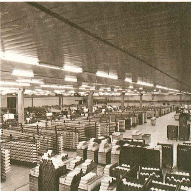
Tek ve katlı bükülmüş bobinler dokuma bölümüne intikal etmek üzere sıra bekliyor.
